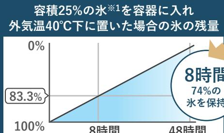
JIS2048(携帯用クーラーボックス)簡便法による試験
